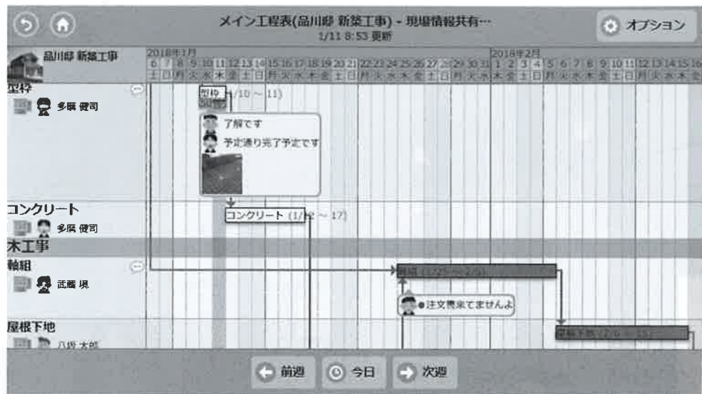
ダイテックが提供する「現場情報共有クラウド」の操作画面。現場監督や協力業者はスマートフォンなどで、どこにいても工程表を確認可能。工程表上には、進捗状況やメッセージの通知も表示される
